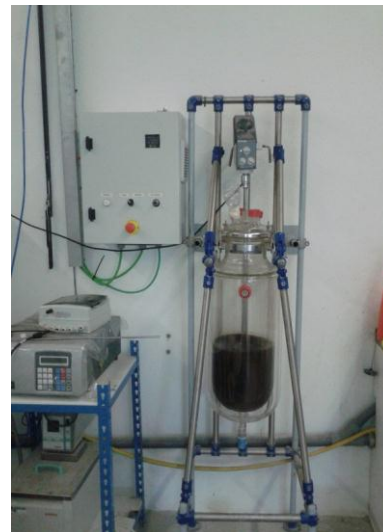
Ensayos en reactor – decantador piloto de 20L
